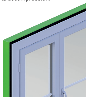
Figure 10 : Jonction angle – Pose en tunnel
