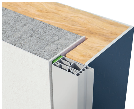
Figure 3 : Tunnel au nu intérieur - ITE avec retour
