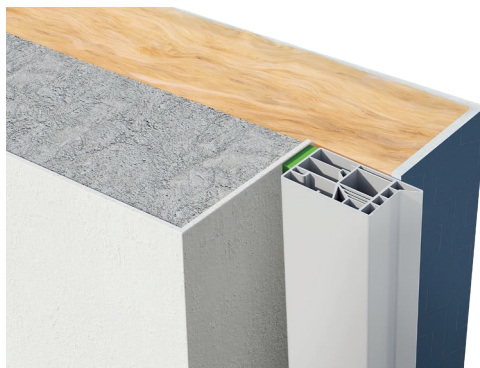
Figure 4 : Tunnel au nu extérieur - ITE sans retour
